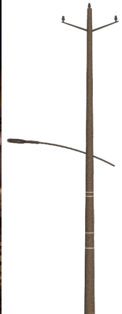
Figure 85 – Luminaire signature sur poteau d'Hydro-Québec en béton centrifugé
