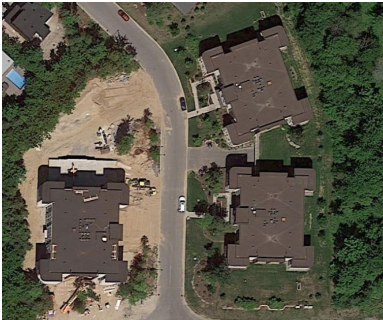
Figure 5. Certains bâtiments du quartier Chambéry sont dotés de toits foncés pouvant contribuer à la formation d'ICU (Google Earth, 2023)
